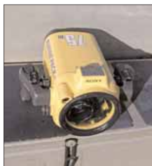
En videokamera med vattentätt hölje används för att dokumentera arbetet på stationerna.
