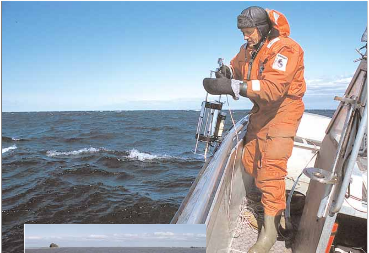
Den stängningsbara vattenhämtaren är oundgänglig för att ta vattenprover från bestämda djup i vattenmassan. Bo Juhlin, SMHI, tar prover i kyligt aprilväder.
