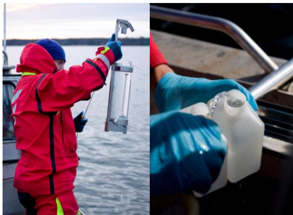
De vattenkemiska provtagningarna görs med en s.k. Limnos-hämtare. Näringsämnen, syrgashalt, klorofyll m. m. analyseras och rapporteras sedan löpande under året.
